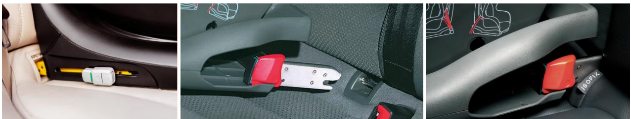
Figure 33. Le système d'ancrage ISOFIX Source : Maxi-Cosi.be et ANWB
