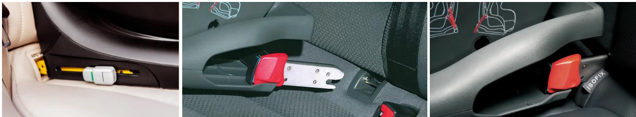
Figuur 33. Het ISOFIX-verankersysteem Bron : Maxi-Cosi.be et ANWB
