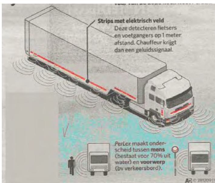
Figuur 33. Illustratie van de werking van een radardetectiesysteem
